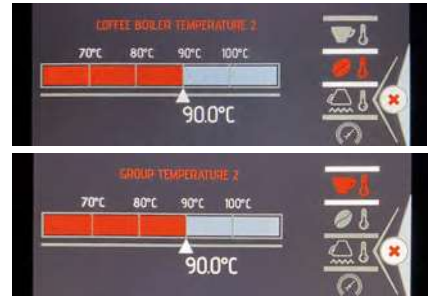
上：コーヒーボイラー温度設定 下：グループボイラー温度設定
